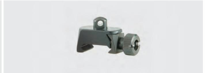
Riemenbügelhalter in drehbarer Ausführung und 8 mm breitem Kopf. Eine Feststellung des Riemenbügelkopfes ist nicht möglich. Die Befestigung auf der Weaver- bzw. Picatinny-Schiene erfolgt mittels Rändelschraube und federndem Gegendruck-Klemmschieber.
