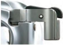
In Zusammenarbeit mit dem bekannten Büchsenmacher Klaus Kästel aus Nürnberg wurde der sogenannte SECURA-Sicherungshebel ( safety lever "SECURA" ) entwickelt. Ein Federmechanismus drückt die Nase einer in den Sicherungshebel integrierten Sperrklinke in eine hierfür vorgesehene Ausnehmung im Gehäuse. So wird verhindert, dass der Sicherungshebel unbeabsichtigt in die Feuer-Position gebracht werden kann. Zum erneuten Sichern muss der Hebel lediglich wieder zurückgezogen werden.
