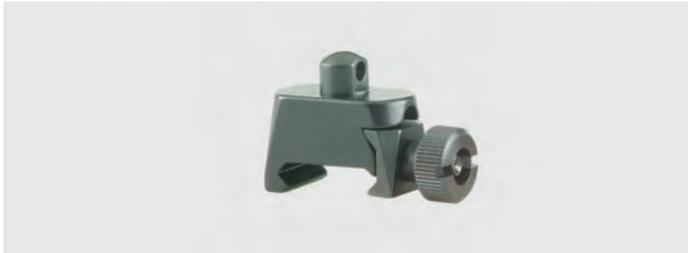
Riemenbügelhalter in dreh- und feststellbarer Ausführung mit 8 mm breitem Kopf. Die Feststellung erfolgt über einen seitlich sitzenden Gewindestift. Wird dieser bis zum Anschlag herausgedreht, ist der Riemenbügelkopf drehbar gelagert. Die Befestigung auf der Weaver- bzw. Picatinny-Schiene erfolgt mittels Rändelschraube und federndem Gegendruck-Klemmschieber.
