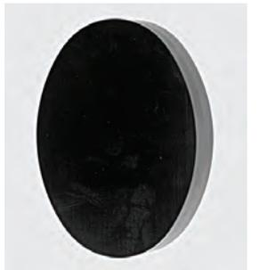
Pistolengriffkäppchen-Rohling aus Büffelhorn. Bohrungen von unten anzentriert.
